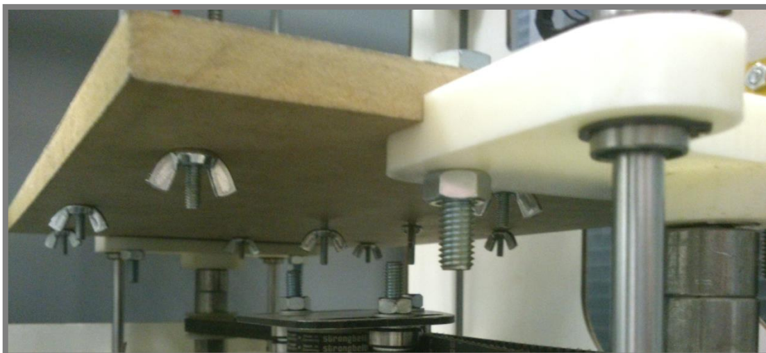
Obr. 10 Šroubové spojení základové desky studentské 3D tiskárny (spodní pohled)
