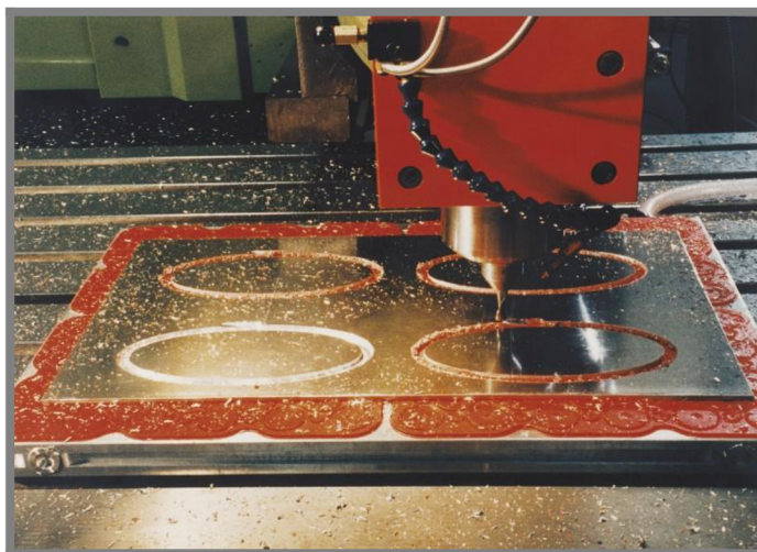
Obr. 8 Příklad vakuového upínání při frézování [23]
