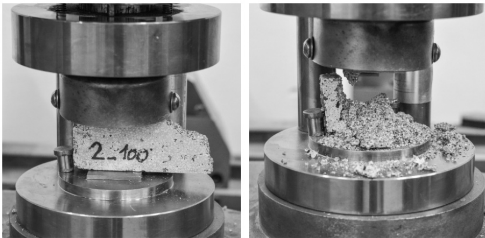
Obr. 2.8: Tlaková zkouška úlošku trámce
