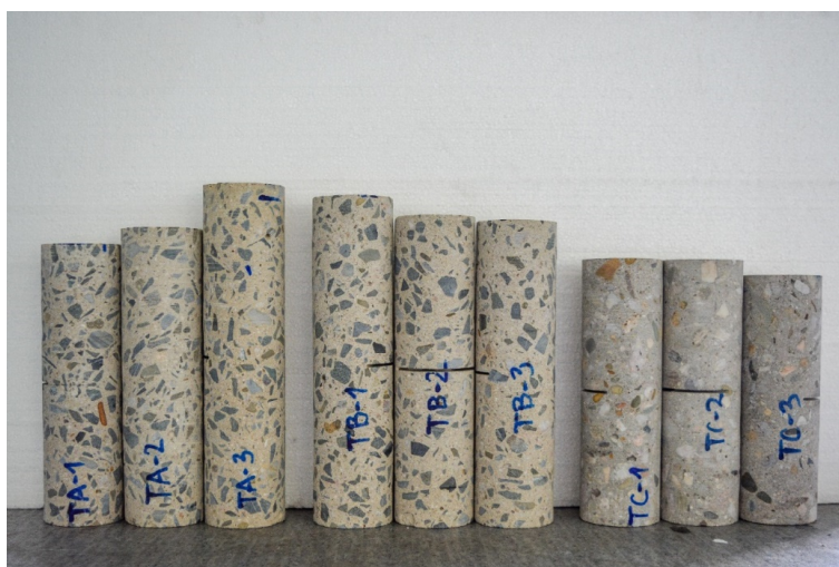
Obr. 2.1: Odebraná tělesa připravená pro lomové experimenty
