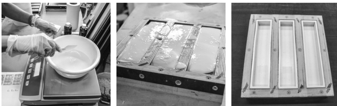
Obr. 2.5: Ilustrace fází výroby silikonových forem
