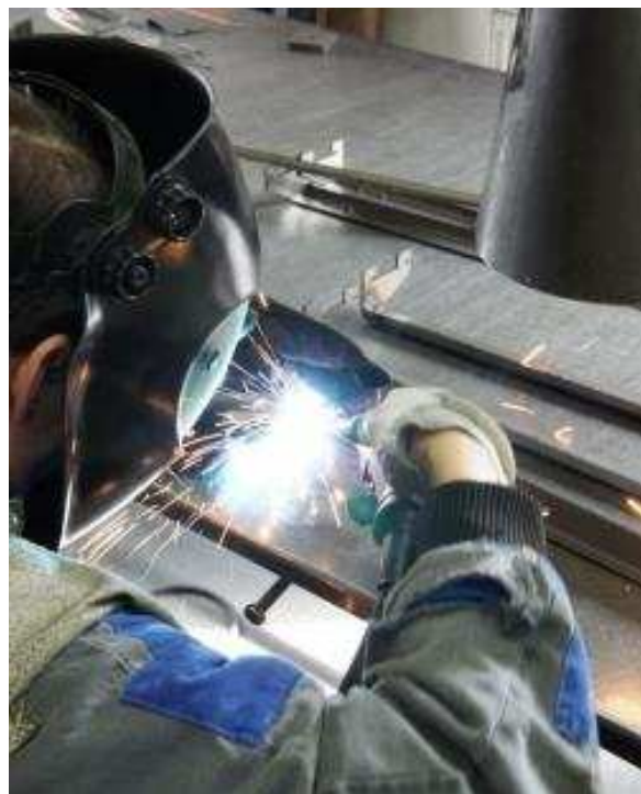
Obr. 12 Příklad svařování metodou MIG/MAG [33]
