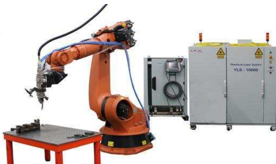
Obr.19 Příklad sestavy pro laserové svařování [48]
