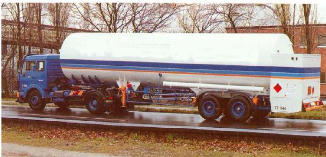
Obr. 26 Autocisterna s kapalným vodíkem [9]
