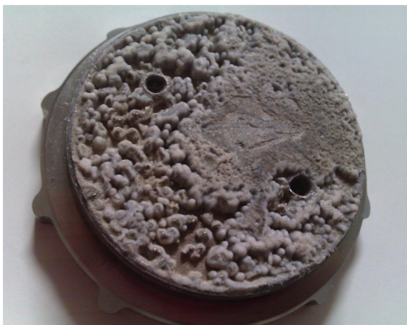
Obr. 14 Víko bubleru, účinek vodíku s vodou na nerezový materiál.
