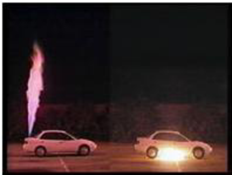
Obr. 13 Ukázka testu úniku vodíku ve srovnání s benzínem. [3]
