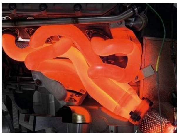
Obr. 46 Tepelné zatížení výfukového potrubí [28]
