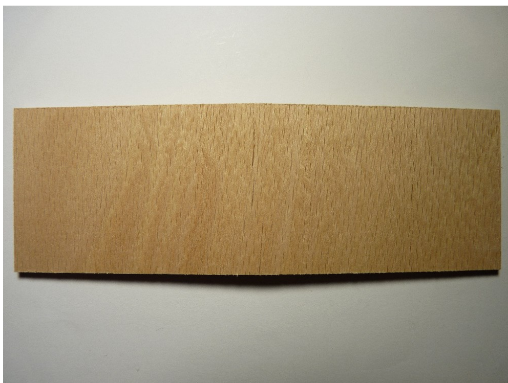
Obr. 14 Těleso porušené v ohybu napříč vláken, lepené lepidlem 1206
