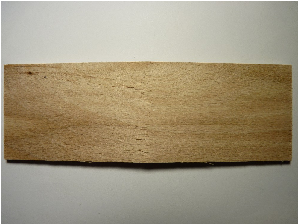
Obr. 11 Těleso porušené v ohybu podél vláken, lepené lepidlem A201
