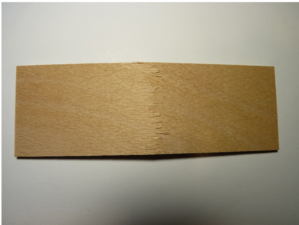
Obr. 12 Těleso porušené v ohybu podél vláken, lepené lepidlem 1206
