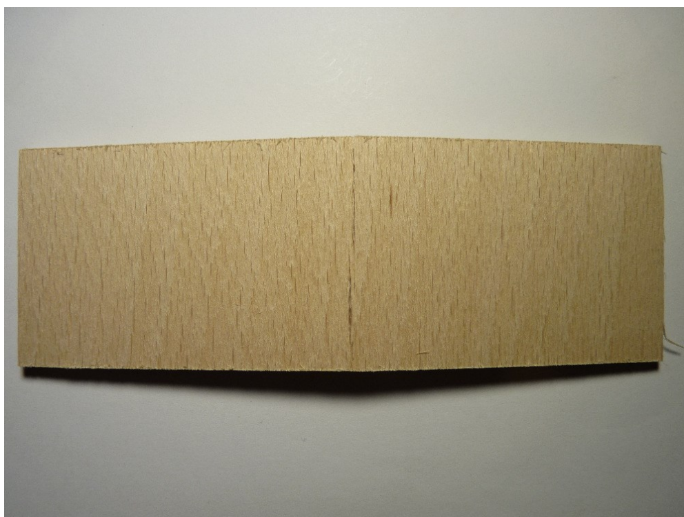
Obr. 13 Těleso porušené v ohybu napříč vláken, lepené lepidlem A201
