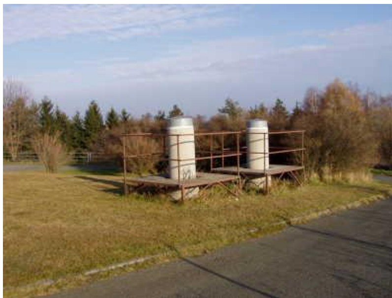
Obrázek 2.7 Pilíře vnitřní základny [25]
