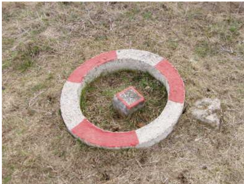
Obrázek 2.10 Bod vnější testovací základny GPS [29]
