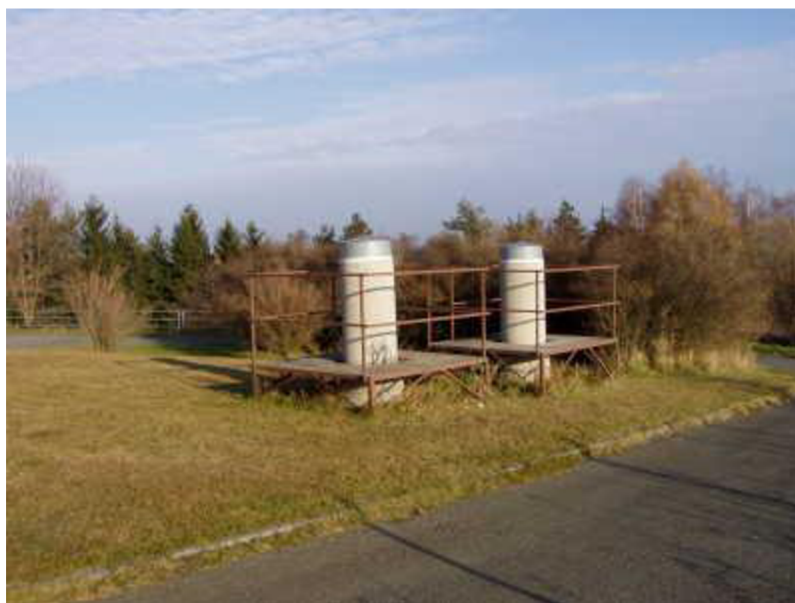
Obrázek 2.7 Pilíře vnitřní základny [25]
