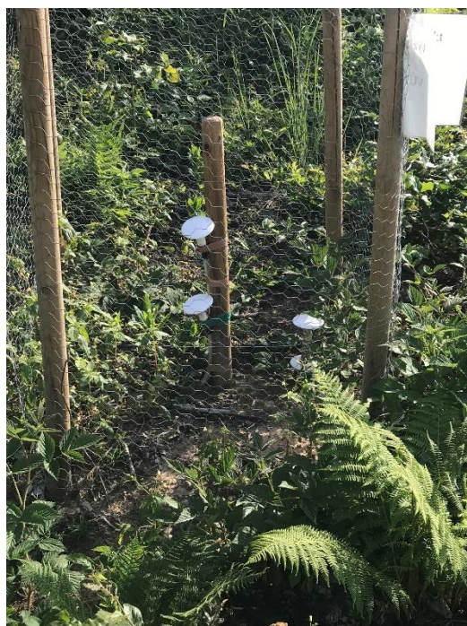
Obrázek 18: Instalované sondy na stanovišti Li3 - Lipnice (foto autor 2022).
