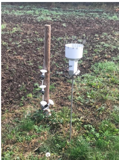
Obrázek 11: Instalované sondy se srážkoměrem na stanovišti F1 - Hovorčovice (foto autor 2022).
