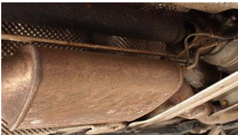
Obr. 4.19. Filtr pevných částic [17]
