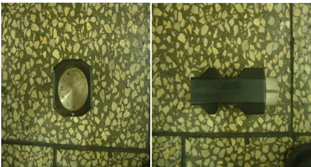
Obr. 3.12. Diagnostický tester blikacího kódu OPEL
