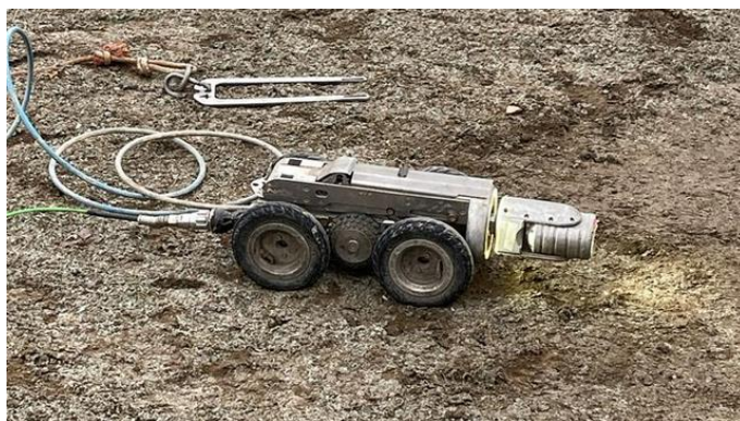
Obrázek 9 - Kanalizační TV kamera (Vlastní)
