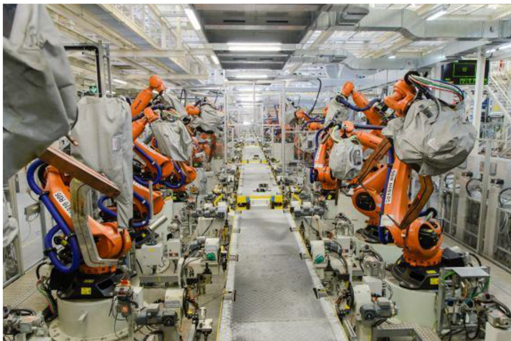
Obr. 1) Svařovací automatizovaná linka na výrobu automobilových karosérií [2]
