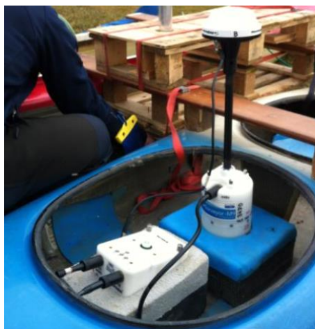
Obr. 12. Součásti měřící soustavy RiverSurveyor M9 umístěné v kajaku.
