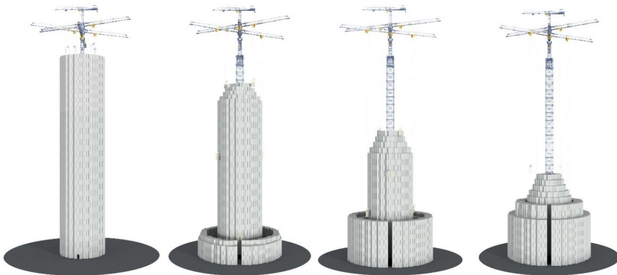
Obr. 22 Postupné vybíjení gravitačního úložiště od Energy Vault [100]
