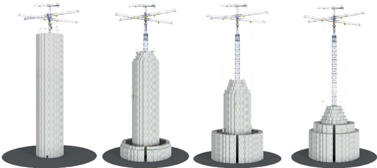
Obr. 22 Postupné vybíjení gravitačního úložiště od Energy Vault [100]
