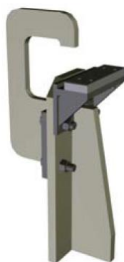
Obr. 6 Podpurný blok k zachycení hmotnosti kroužku s ozubeným věncem. [18]
