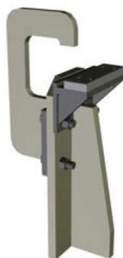
Obr. 6 Podpůrný blok k zachycení hmotnosti kroužku s ozubeným věncem. [18]
