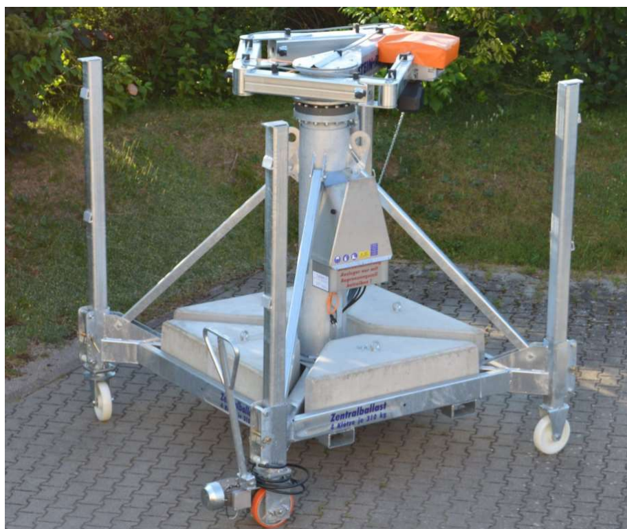
Obrázek 5: Složený jeřáb Stai-Rex 2.0 [2]
