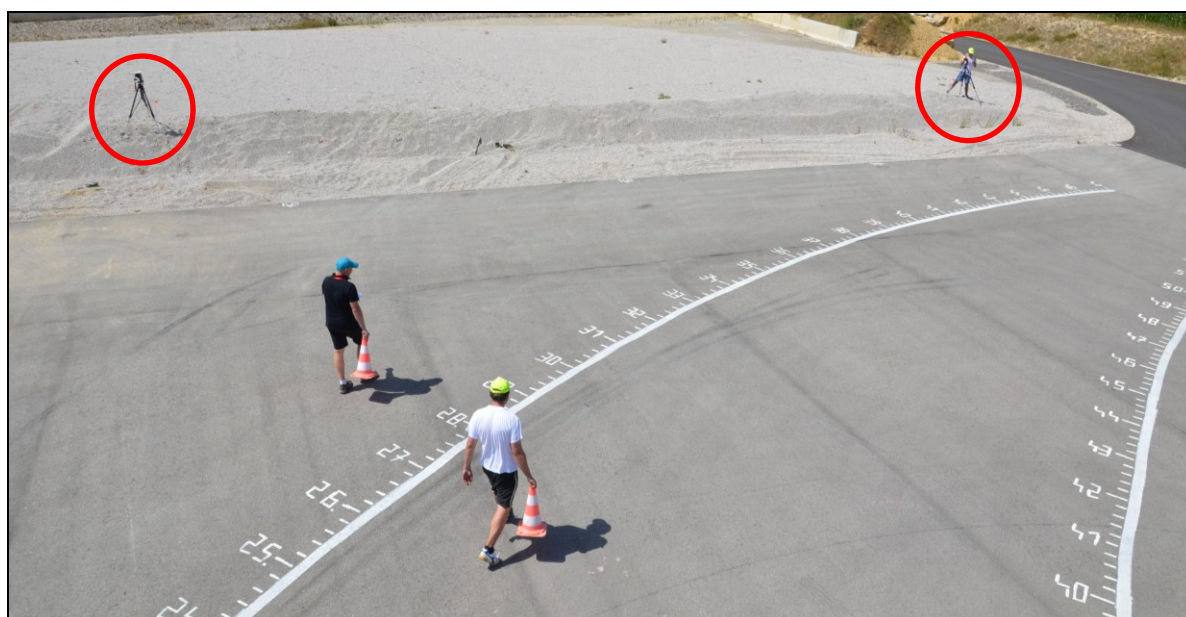
Obr. 107: Poloha vysokorychlostních statických kamer snímajících pohyb a brzdění vozidla v obloucích (poloha kamer vyznačena červeně)
