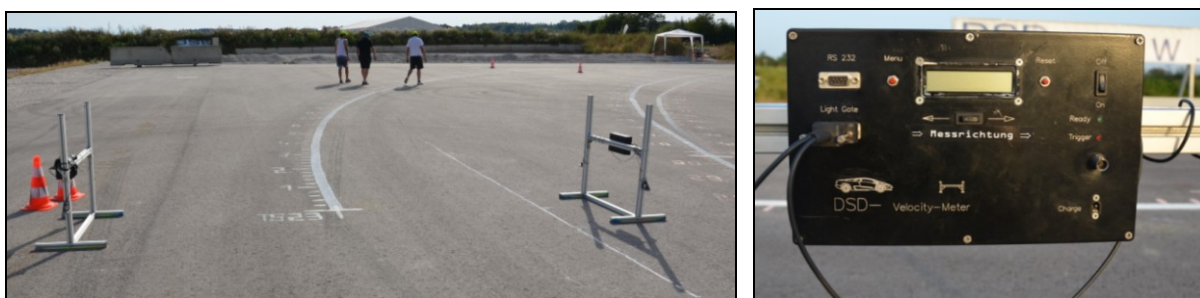
Obr. 101: Světelná brána (obrázek vlevo - poloha brány v oblouku, vpravo - detail na ovládací panel brány)
