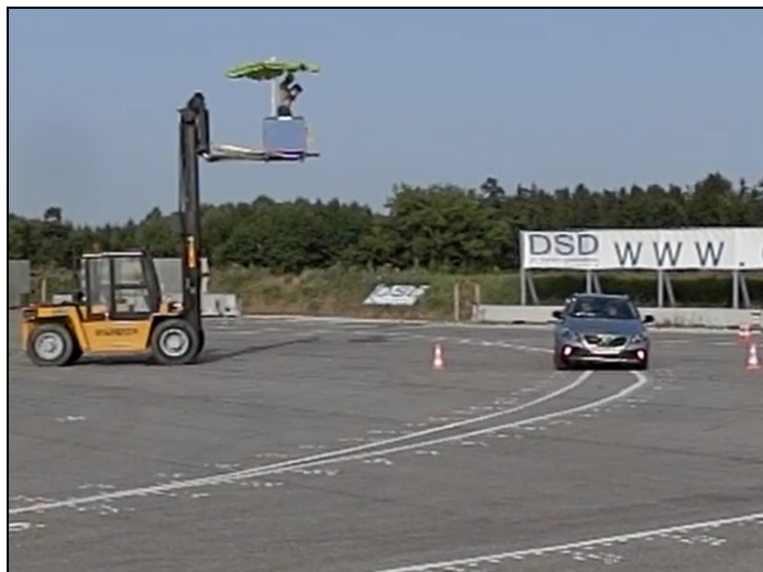
Obr. 104: Kamera na vysokozdvížečné plošině
