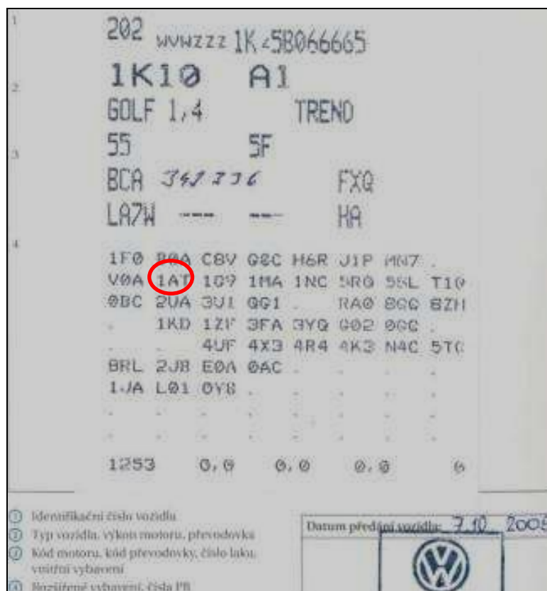
Obr. 14: Datový štítek vozidla (červená elipsa: kód výbavy „1AT“ = výbava systémem ESP) [55]
