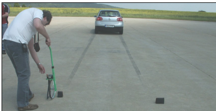
Obr. 22: Kontrolní přímé měření brzdné dráhy měřicím kolečkem (změřena délka brzdné stopy 13,5 m)
