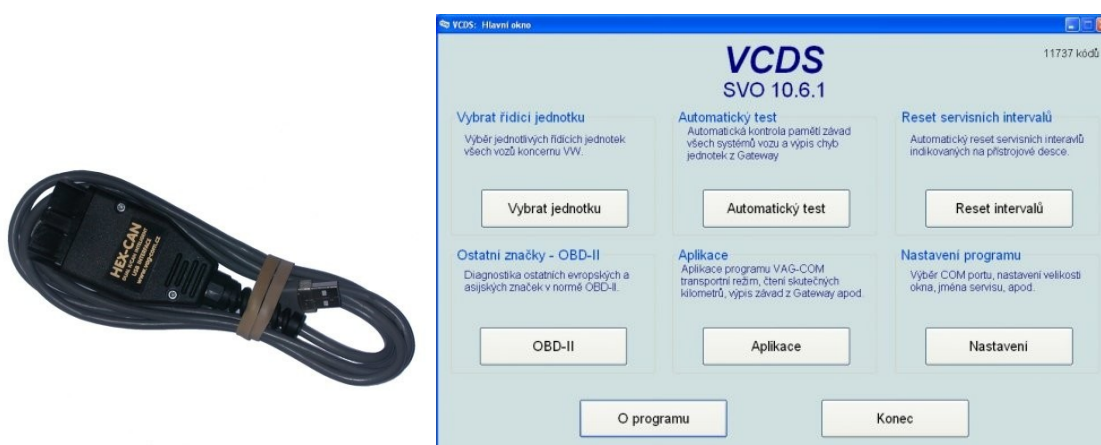
Obr. 19: Diagnostický kabel HEX-CAN a SW prostředí programu VAG-COM 10
