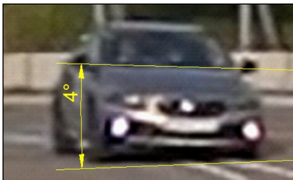
Obr. 115: Naklopení karoserie vozidla Volvo během pilotního testu před zahájením měření, rychlost jízdy 70 km/h, oblouk o poloměru 40 m
