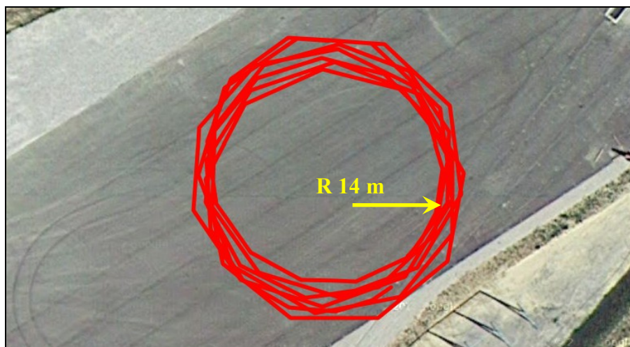
Obr. 122: Zrekonstruovaná trajektorie průjezdů při kruhové zkoušce z dat DGPS
