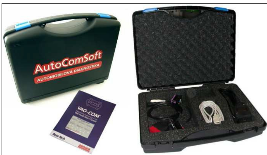
Obr. 18: Diagnostická sada VAG-COM PROFÍ 9
