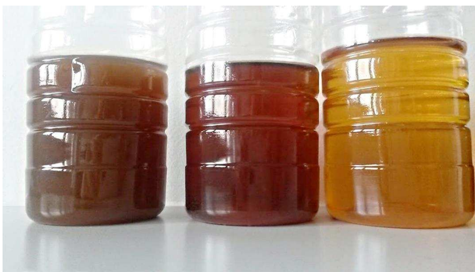
Obrázek 6: Srovnání jednotlivých reálných vzorků po extrakci dle Soxhleta s různou koncentrací rozpouštědla (vlevo destilovaná voda, uprostřed 50% ethanol, vpravo 99,99% ethanol)
