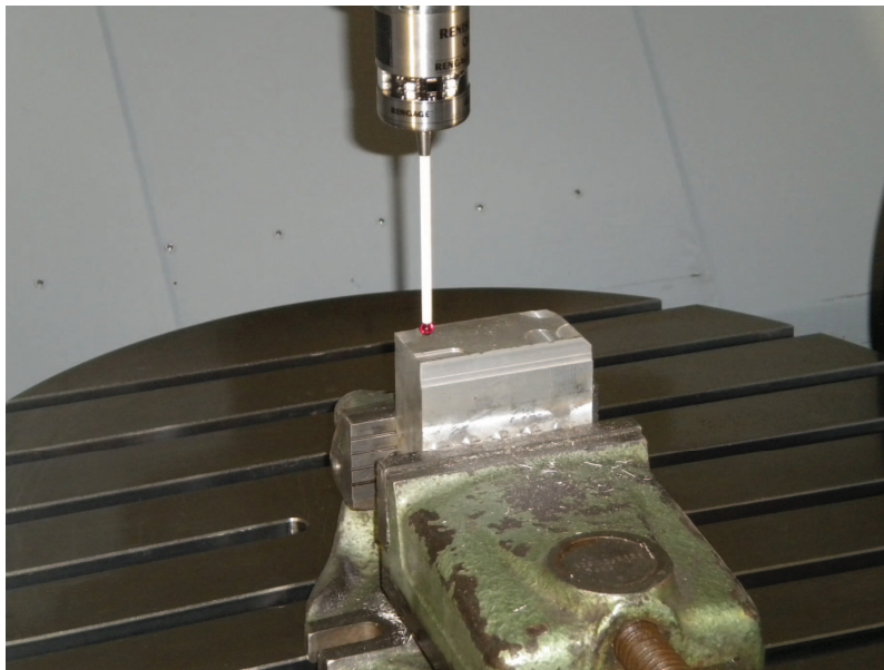
Obr. 3.6 Odměřování nulového bodu obrobku sondou OMP 400
