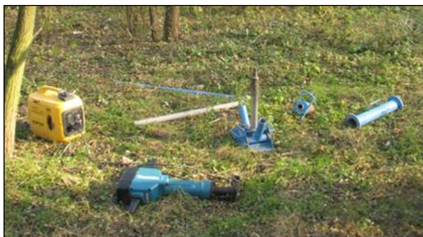
Obr. 5: Vibrační souprava pro vrtání do sypkých sedimentů (Foto: MGR. MARTIN FAMĚRA).
