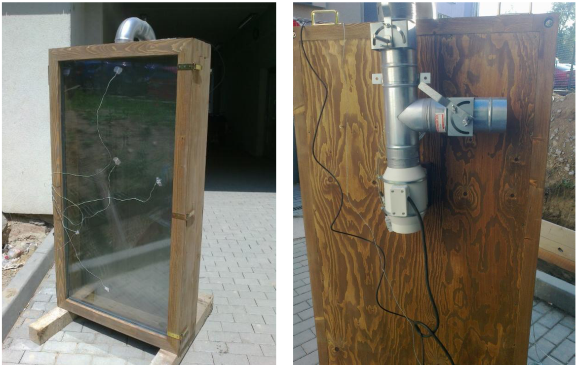
Obr. 2: fyzický model kolektoru - přední a zadní strana
