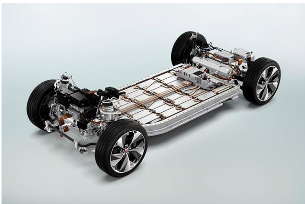
Obr. 10 Hnací ústrojí a uložení baterií vozu Jaguar I-Pace
