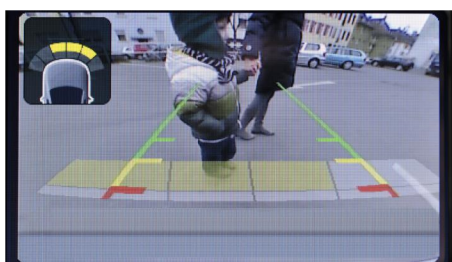
Obrázek 2.14: Příklad výstupu z couvací kamery, kde jsou na monitoru zobrazeny čáry s odhadem vzdálenosti a současně může být například naznačena trasa vozidla v dané chvíli. [18]
