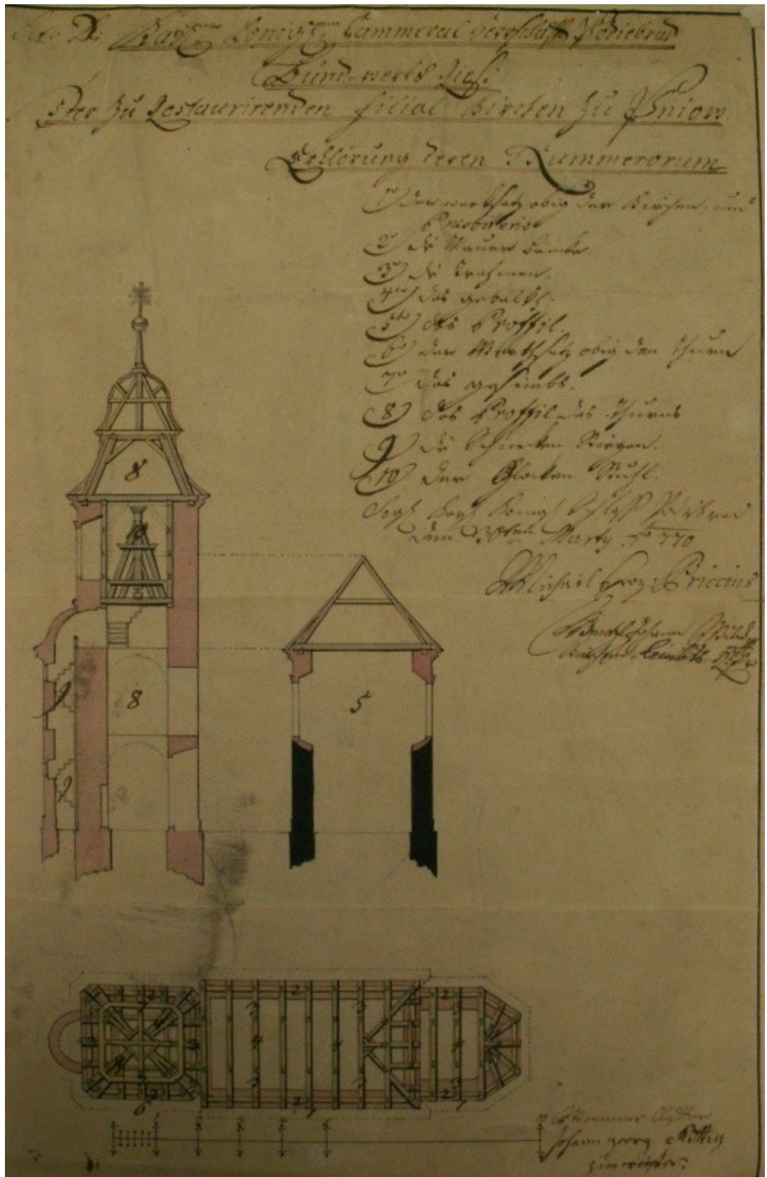
Obrázek 85 Pňov-Předhradí, kostel Narození Panny Marie, plány na přestavbu věže, H. J. Rüttig
