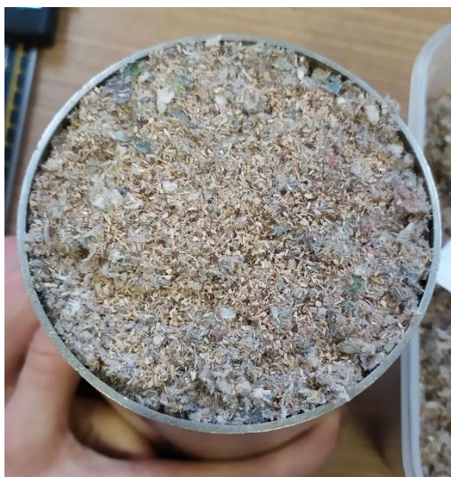
Obrázek 33: Vzorek umístěný v držáku velké Kuntovy trubice
