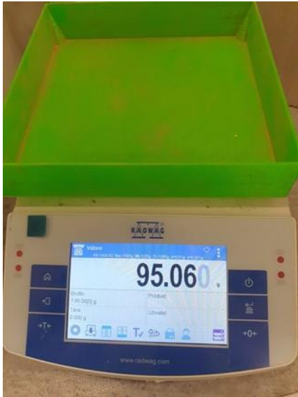
Obrázek 28: Plastový rámeček pro stanovení součinitele tepelné vodivosti
