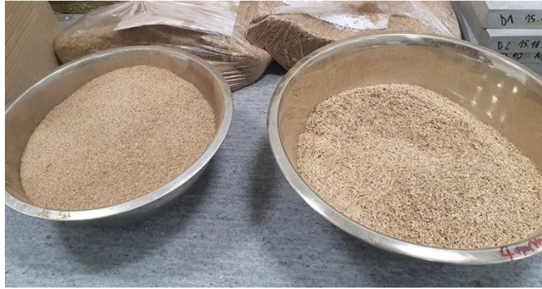
Obrázek 18: Vzorky upravené dřevní štěpky (vlevo jemná štěpka, vpravo hrubá štěpka)
