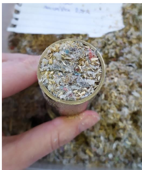
Obrázek 31: Vzorek umístěný v držáku malé Kuntovy trubice
