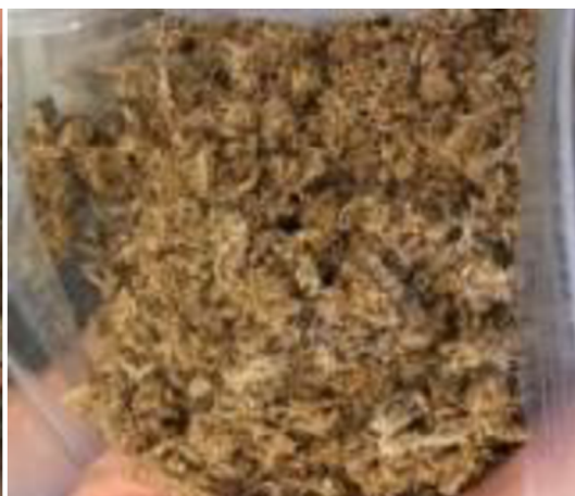
Obrázek 6: Foukaná izolace na bázi mechu [35]
