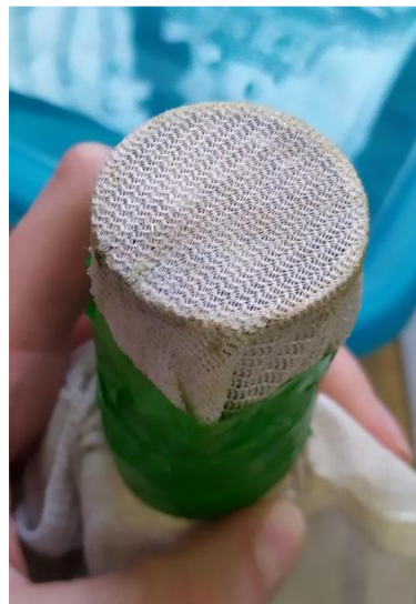
Obrázek 31: Držák vzorku opatřený sítkou
