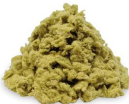
Obrázek 2: Foukaná izolace na bázi minerální vlny [28]
