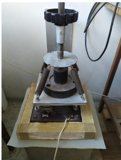
Obrázek 34: Zkušební zařízení pro stanovení dynamické tuhosti
