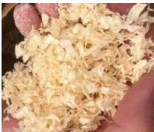
Obrázek 8: Foukaná izolace na bázi dřevěných hoblin [35]
