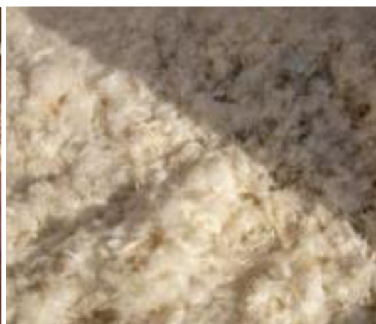
Obrázek 7: Foukaná izolace na bázi kuřecího peří [35]
