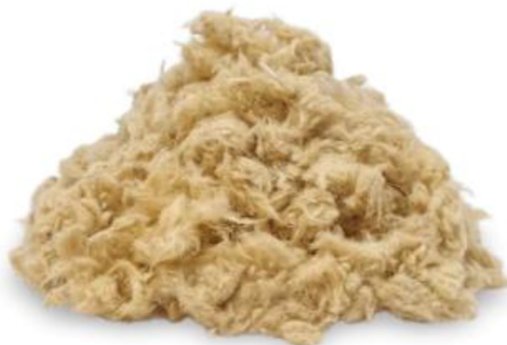
Obrázek 3: Foukaná izolace na bázi skelné vlny [30]
