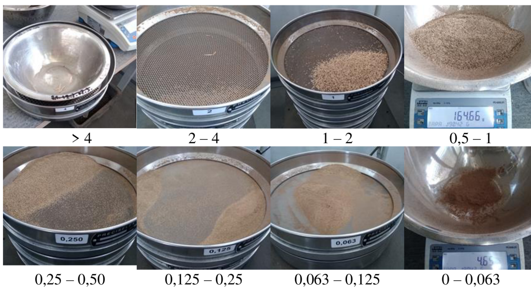
Obrázek 37: Síťový rozbor jemné štěpky
