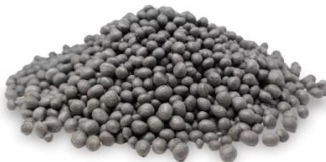
Obrázek 1: Foukaná izolace na bázi polystyrenu [26]
