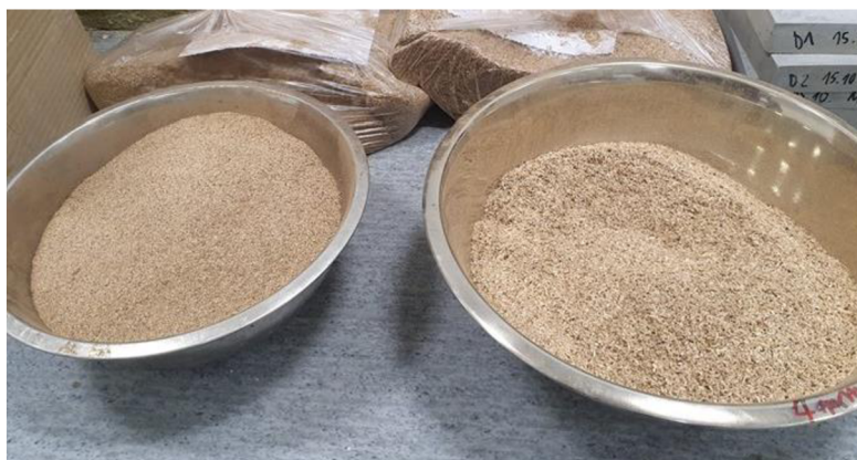
Obrázek 18: Vzorky upravené dřevní štěpky (vlevo jemná štěpka, vpravo hrubá štěpka)
