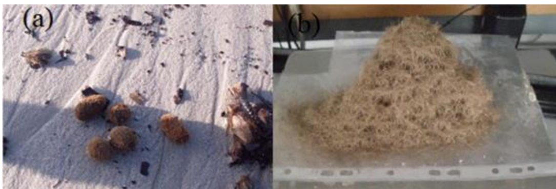
Obrázek 10: a) Kuličky Posidonia Oceanica ; b) Extrahovaná mořská vlákna [37]
