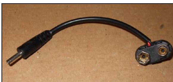
Obr. 6.11: Redukce pro propojení kamery a baterie 9 V.
