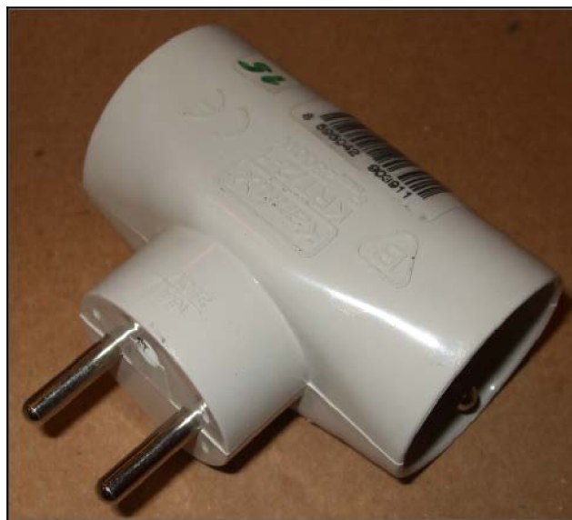
Obr. 6.3: Odposlechový přístroj v elektrickém rozbočovači [a].
