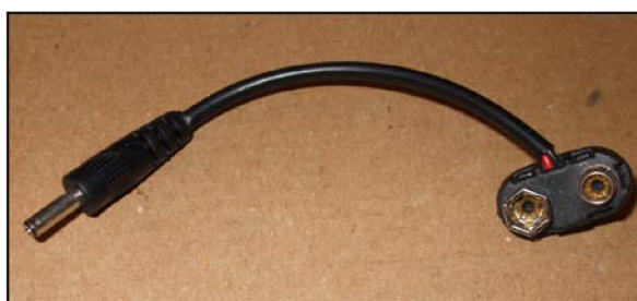
Obr. 6.11: Redukce pro propojení kamery a baterie 9 V.
