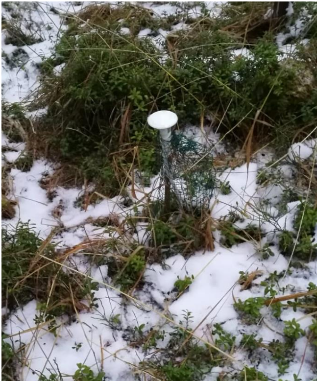
Obrázek 6. Půdní čidlo TMS na výzkumné ploše. Čidlo je opatřené ochranným pletivem, proti okusu zvířete.
