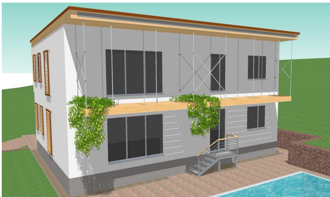
Obr. 26: Způsob stínění jižní strany fasády objektu
