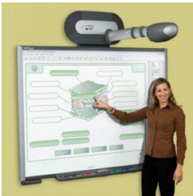
Obrázek 10 Interaktivní tabule s integrovaným dataprojektorem
