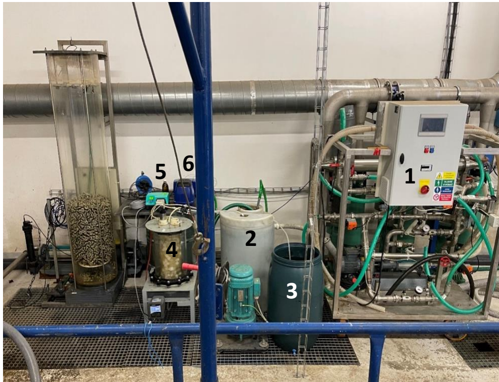
Obr. 6 Poloprovozní systém post-nitrifikace s kolonou (na ČOV Amazon) pro testování vyvinutých nosičů S: 1. filtrační jednotka s keramickým membránovým modulem; 2. barel s kalem z nitrifikační nádrže; 3. barel na jímání permeátu z filtrační jednotky; 4. kolona s nosiči; 5. peristaltické čerpadlo; 6. vzduchové dmychadlo
