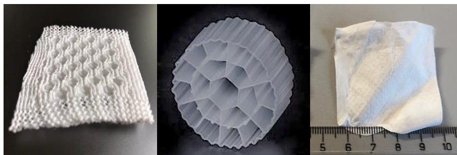
Obr. 41 Fotografie nosičů biomasy (zleva): mikrovláknenný nosič X, AnoxKaldnes K3 a nanovláknenný nosič
