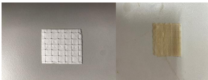
Obr. 39 Nově vyvinutý nanovláknový nosič biomasy mechanicky stabilizovaný silikonovou mřížkou před a po biologickém testování
