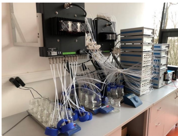
Obr. 10 Fotografie respirometru používaného k měření aktivit biofilmu na testovaných nosičích biomasy; zařízení umístěné v klimatizované místnosti temperované na 20 °C
