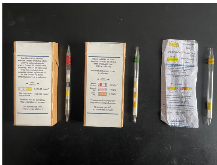
Obrázek 8: možné podoby detekčních trubiček. Konkrétně detekční trubičky společnosti Oritest ve výbavě HZSMSK. Zdroj: vlastní zpracování
