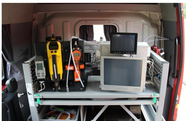
Obrázek 16: Interiér protichemického vozidla hasičů v Berlíně. v levé části obrázku lze vidět infračervený spektrometr a vedle něj Tiger XT. Sníkem poskytnut p. Holgerem Notzkem.
