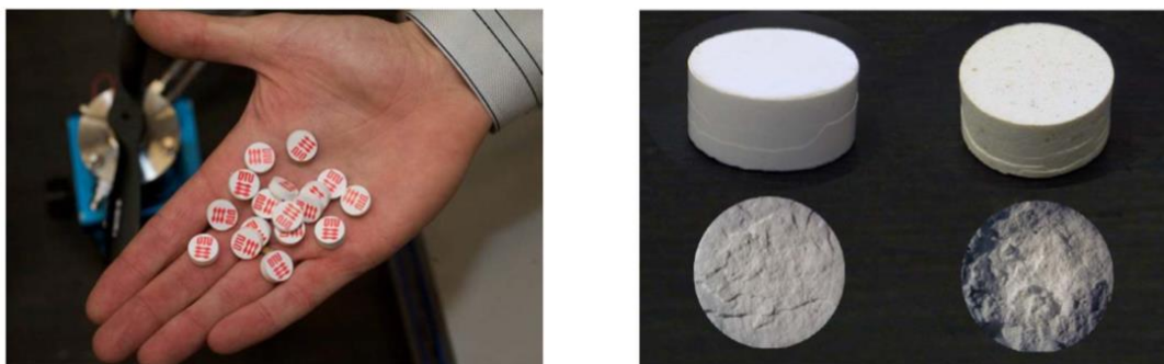
Obr. 11 Skladování absorpcí, tablety Mg(NH 3 ) 6 Cl 2 [19]
