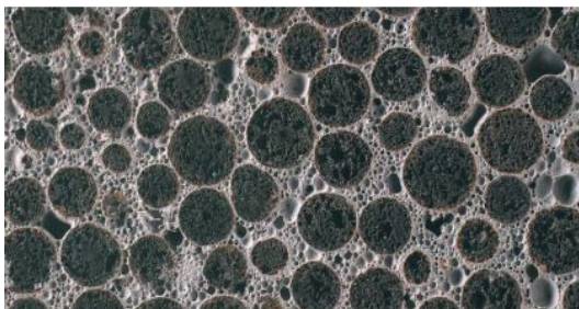
Obrázek 15 Kombinace vylehčení – Liapor a pěnotvorná přísada [5]
