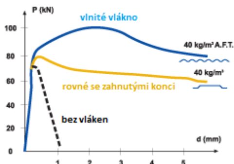
Obrázek 6 Srovnání pracovních diagramů dle tvaru vláken [6]
