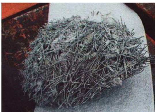
Obrázek 14 Shluk vláken (ježek) v čerstvém betonu [20]
