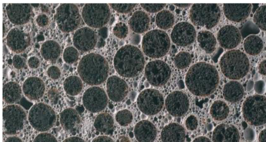
Obrázek 15 Kombinace vylehčení – Liapor a pěnotvorná přísada [5]
