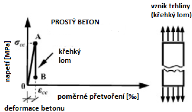
Obrázek 8 Porušení prostého betonu – křehký lom [11]
