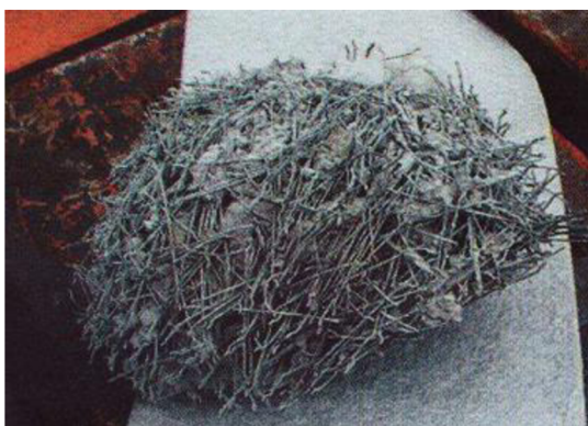
Obrázek 14 Shluk vláken (ježek) v čerstvém betonu [20]
