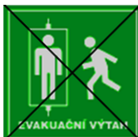
Obrázek 8 Bezpečnostní značení – Tento výtah neslouží k evakuaci osob
