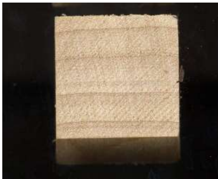
Obrázek 7: Vzorek naskenovaný k měření šířky letokruhů
