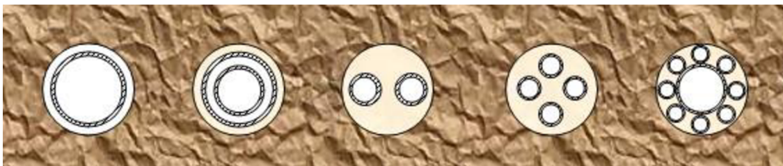
Obrázek 7: Půdorysné uspořádání výměnkových kanálů BHE [19]
