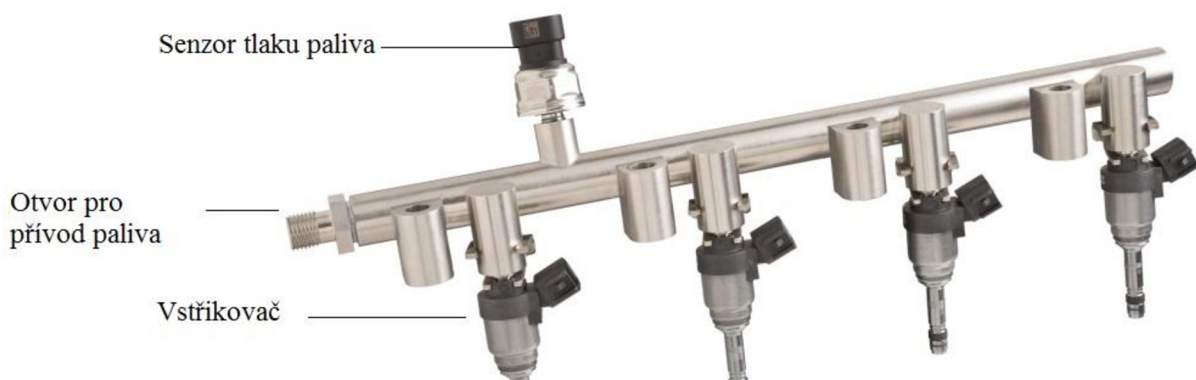
Obrázek 6 Rozdělovač paliva [17]
