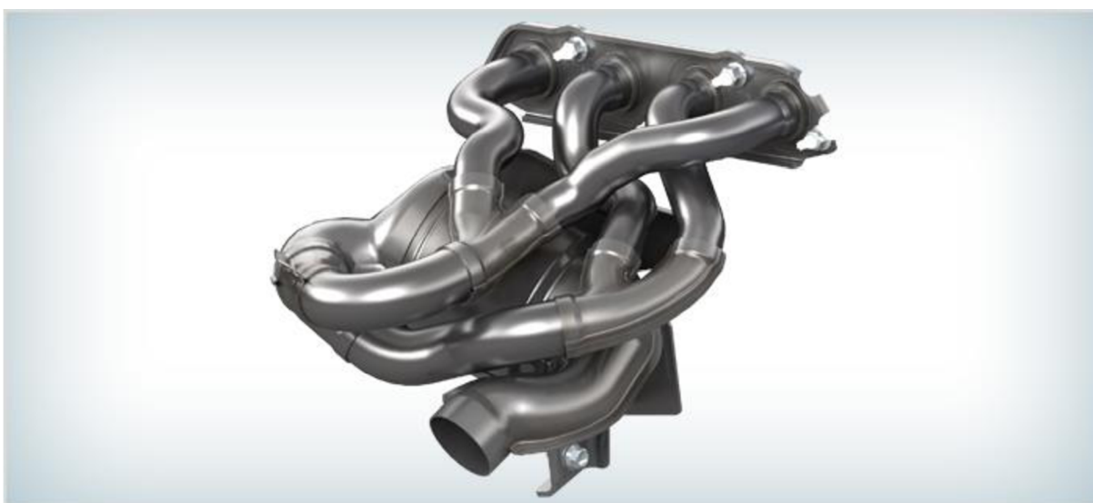
Obrázek 23 Výfukové potrubí motoru 2,0Skyactiv G[10]
