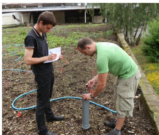
Obr. 43 Čtvercová síť pro měření axiálním anemometrem, zahájení měření (Zdroj: Urban, L, 2012)
