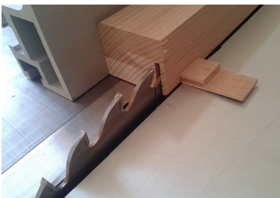
Obr. 2: Krácení vzorků na přesný rozměr v přípravku z hranolku
