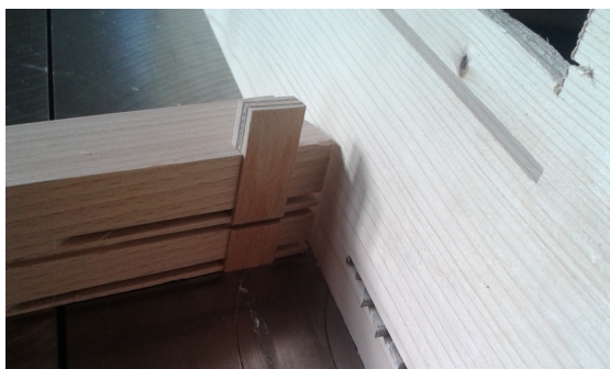
Obr. 5: Vyříznutí drážky do vzorků určených pro zatížení na smyk
