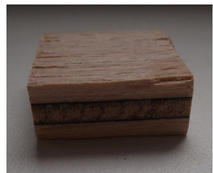
Obr. 3: Zkušební tělíska pro zkoušku na tlak
