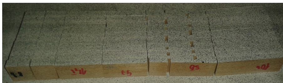
Obr. 13: Aplikace „patternu“ pro sledování deformací při DIC analýze
