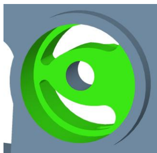
Obr. 96 Nálitek a rozvodné drážky olejového čerpadla
