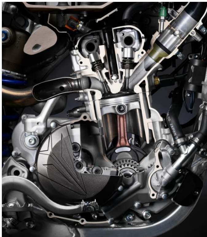
Obr. 9 Pravý pohled v řezu motor Yamaha YZ450F [7]
