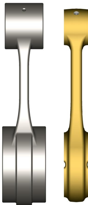
Obr. 32 Ojnice vyhovující výpočtu a konstrukci (pohled z boku)
