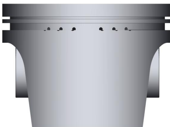
Obr. 20 Plášť pístu vyhovujícího pevnostnímu výpočtu
