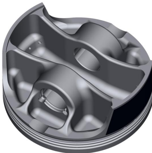
Obr. 24 Výstužná žebra pístu odpovídajícímu konstrukci
