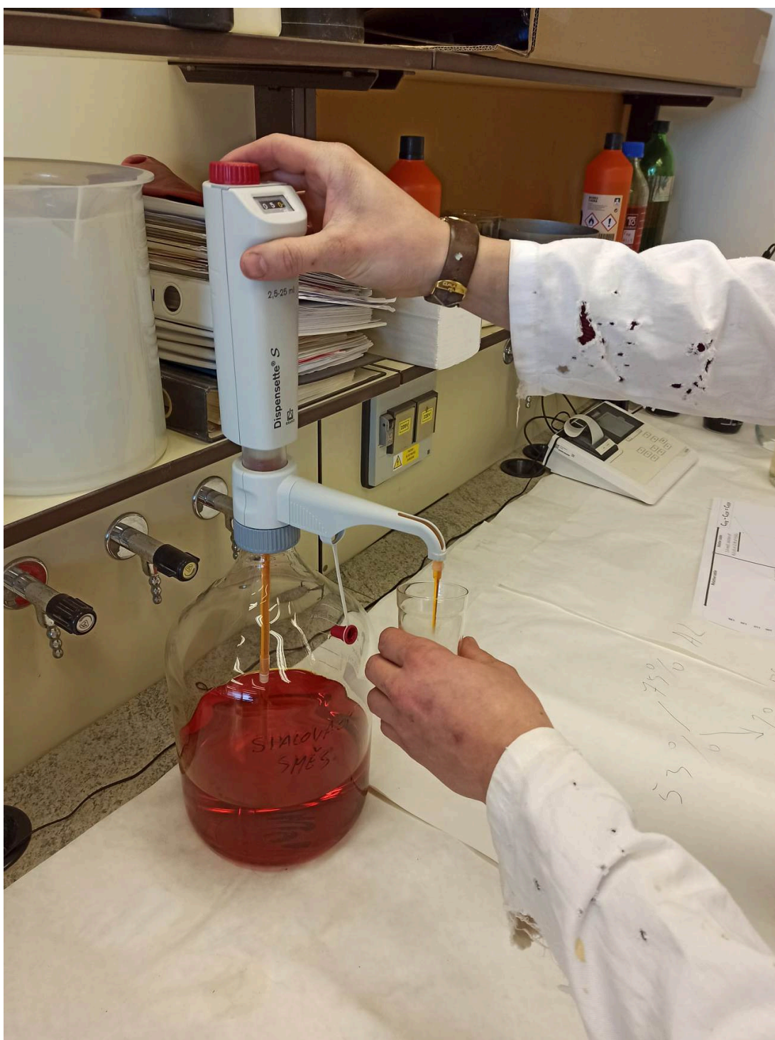
Obrázek 12: Přidávání spalovací směsi k navážené půdě
