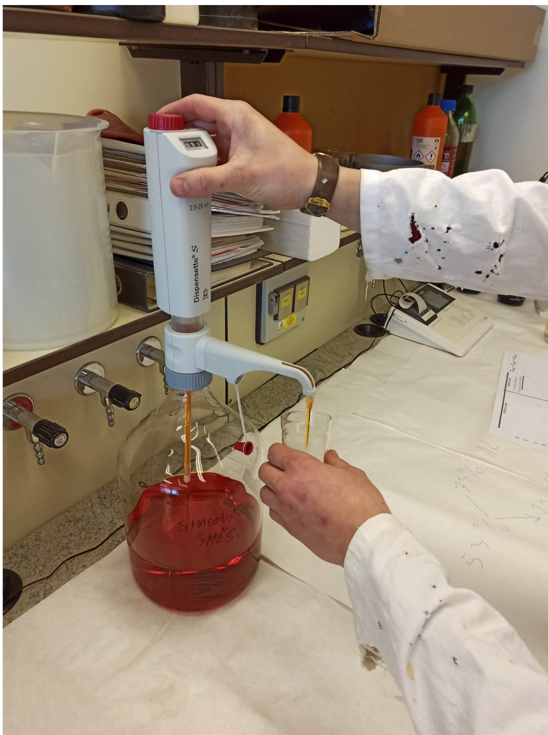
Obrázek 12: Přidávání spalovací směsi k navážené půdě
